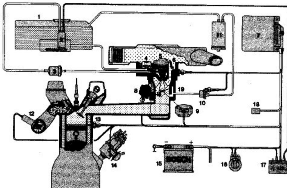
Essa figura representa o esquema de um sistema de injeção Mono-Jetronic. Os números 2, 3, 7 e 11 representam, respectivamente:
