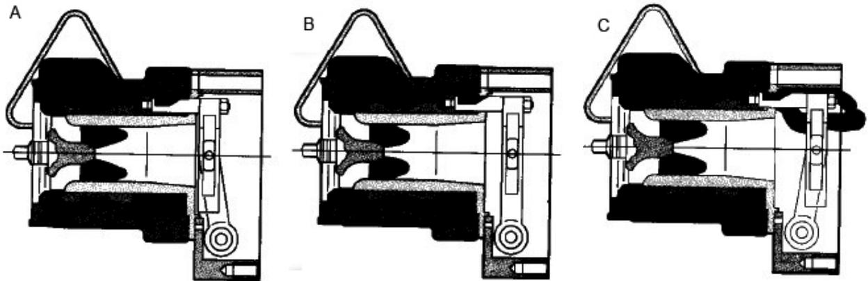
As figuras apresentam um sobrealimentador para motores de combustão interna com:
