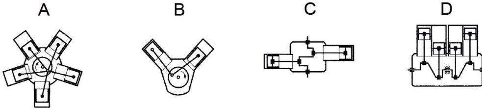
As figuras A, B, C e D, que representam a disposição de cilindros em motores de combustão interna, são respectivamente, em:
